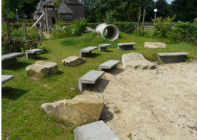
Hergebruik van betonnen u-elementen in een buitenlokaal bij Stichting Lindenhout, Apeldoorn. Beeld: Anneke Rodenburg
